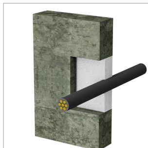
17 b. Kabelgjennomføringer ≤270 x 270/ Ø300 mm
