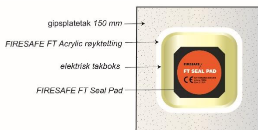
Figur 9 – Elektrisk takboks plassert i gipstak – sett fra undersiden
