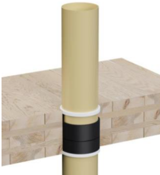
Fig.7 Firesafe Wrap LX på rør i en gjennomføring sammen med Firesafe FT Acrylic (grått materiale) på begge sider av dekke.
