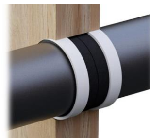
Fig.5 Firesafe Fire Wrap på rør i en gjennomføring sammen med Firesafe FT Acrylic (grått materiale) på begge sider av vegg.
